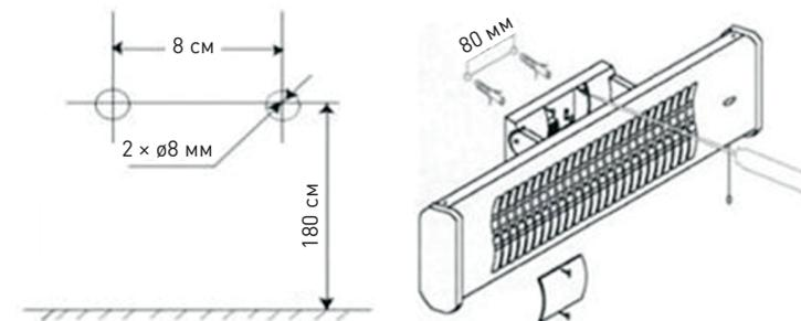
3. Затяните винты соединительной коробки, чтобы зафиксировать изделие под максимальным углом наклона 55 градусов для IV-12 и IV-15 и 45 градусов для IV-18 и IV-20.
