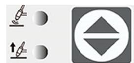
ВЫБОР МЕТОДА ПОДЖИГА ДУГИ: КАСАНИЕМ TIG LIFT
