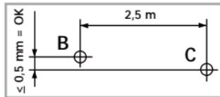
! Verificar regularmente a calibragem antes do uso e depois de transporte e armazenamento prolongados.
