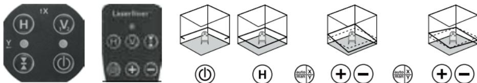
**6 Ajustar a inclinação vertical até no máx. 3° (eixo Z)**
