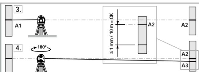
**!** Laite on kalibroitava, jos pisteen A2 ja A3 välisen erotuksen on suurempi kuin  $1 \text{ mm} / 10 \text{ m}$ . Ota yhteys paikalliseen laitetoimittajaan tai UMAREX-LASERLINER huolto-osastoon.
