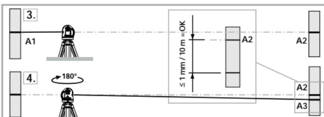
**!** Pokud jsou body A2 a A3 od sebe vzdáleny více než 1 mm / 10 m, je nutné provést kalibraci. Spojte se s Vaším specializovaným prodejcem nebo využijte servisního oddělení společnosti UMAREX-LASERLINER.
