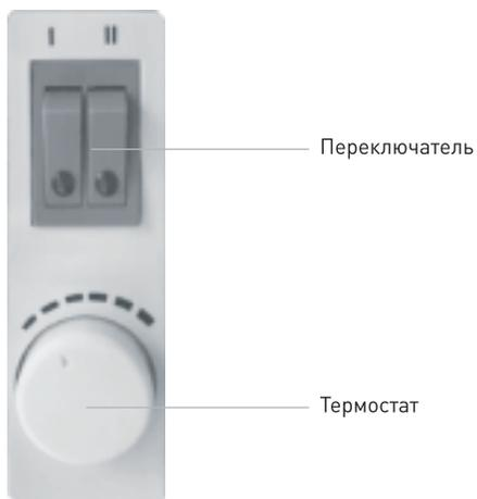
Поверните терморегулятор по часовой стрелке до конца, нажмите на один из переключателей мощности I или II, чтобы включить конвектор на половину мощности (каждый переключатель отвечает за работу на половину мощности), загорится соответствующий переключателю индикатор. Для включения конвектора на максимальную мощность нажмите оба переключателя мощности.
